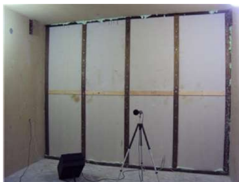
Figura 2: Montaje del muro compuesto por paneles de fibrocemento, poliestireno y placas de yeso en las cámaras de transmisión reverberante del Laboratorio de Acústica de la UFSM.
