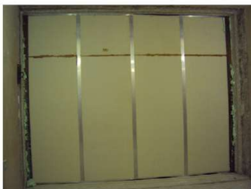
Figura 2: Montagem da parede de painéis de fibrocimento, poliestireno e gesso acartonado nas câmaras reverberantes de transmissão do Laboratório de Acústica da UFSM.
