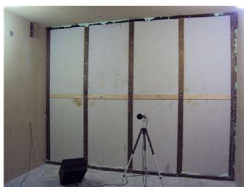
Figura 2: Montagem da parede de painéis de fibrocimento, poliestireno e gesso acartonado nas câmaras reverberantes de transmissão do Laboratório de Acústica da UFSM.
