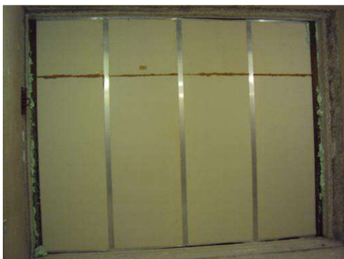
Figura 2: Montaje del muro compuesto por paneles de fibrocemento, poliestireno y placas de yeso en las cámaras de transmisión reverberante del Laboratorio de Acústica de la UFSM.
